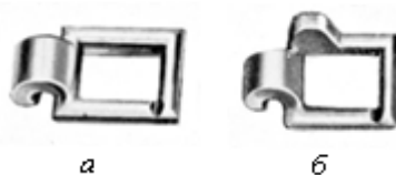
Рис. 1.21. Звено счетной цепи: а – без кнопки; б – с кнопкой
