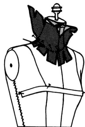
Рисунок 69 – Отогнуть воротник и нанести на ткань линию горловины, начиная сзади от линии середины спины до линии середины переда
