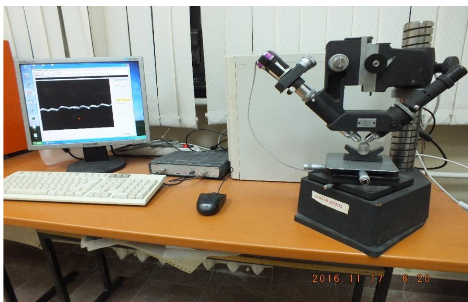
Рис. 8.9. Измерение шероховатости поверхности на микроскопе МИС-11 с ТВ-камерой
