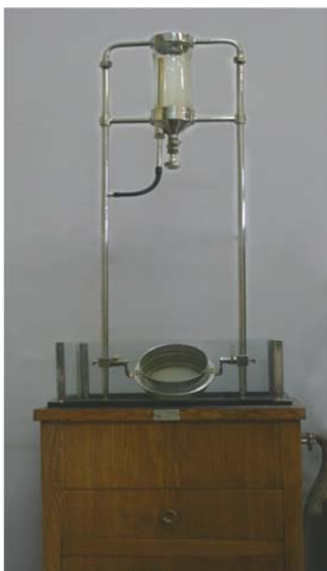
Рис. 12.1. Общий вид дождевальной установки и пенетрометра
