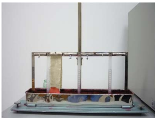
Рис. 13.2. Общий вид устройства для определения капиллярности текстильных материалов
