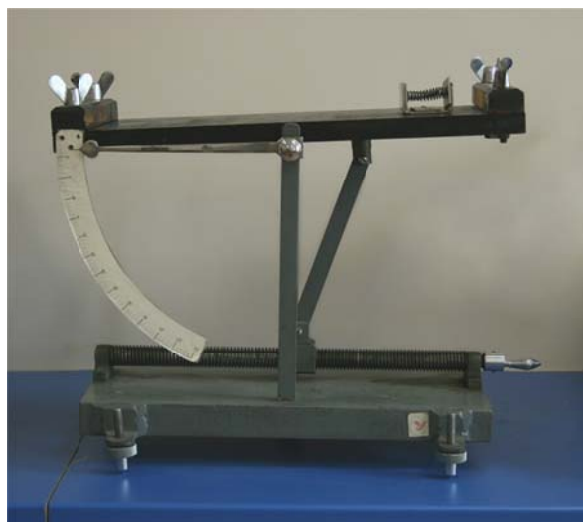
Рис.18.1. Общий вид прибора «Наклонная плоскость»
