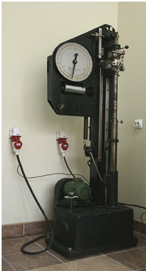
Рис. 19.1. Общий вид и схема разрывной машины РТ-250:
