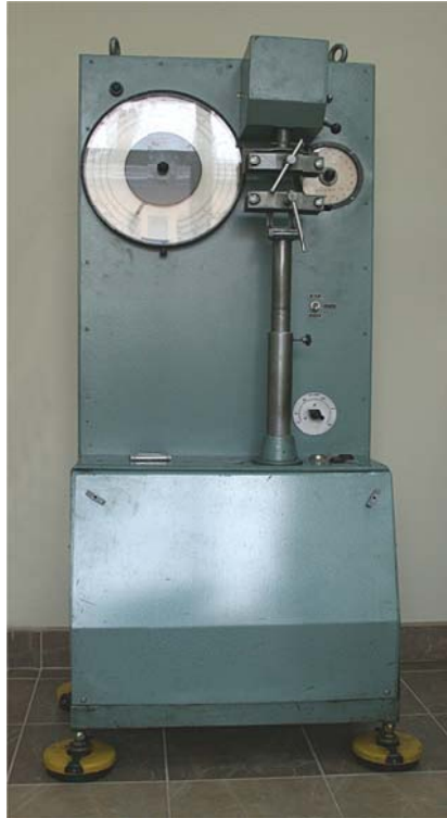
Рис. 19.2. Общий вид разрывной машины РТ-250М
