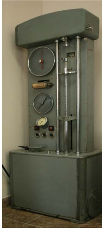
Рис. 21.2. Общий вид разрывной машины FF-04 (SS-02)
