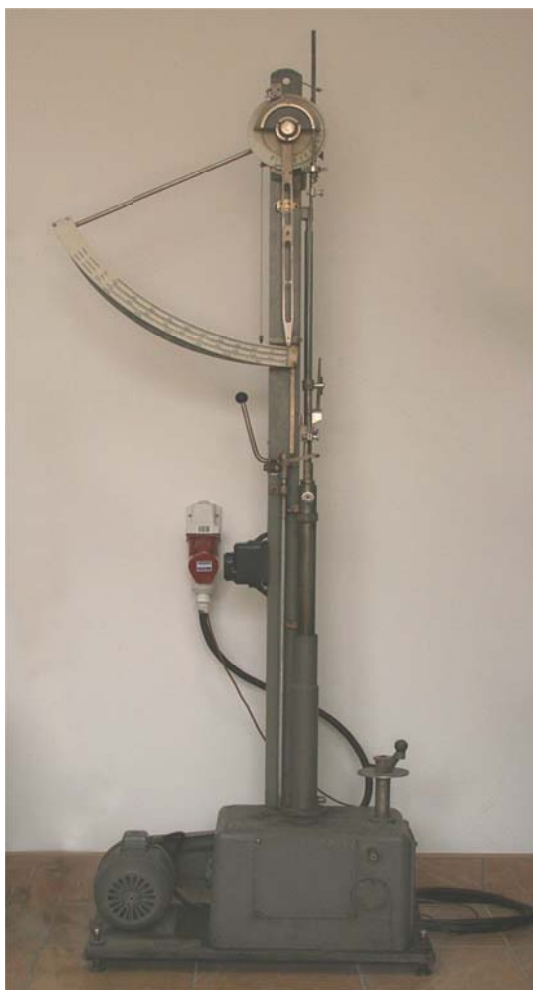
Рис. 5.1. Общий вид и схема разрывной машины РМ-3:
