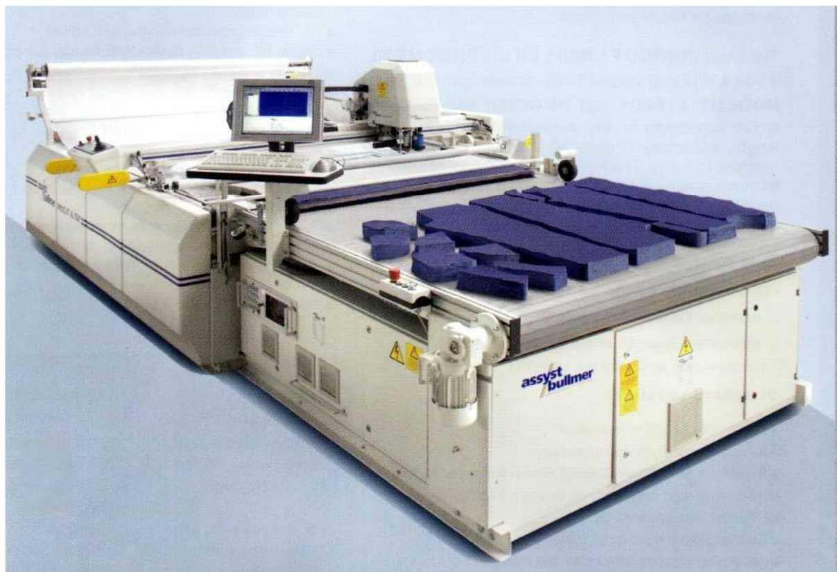
Рис. 17. Автоматизированный технологический комплекс раскроя материалов с программным обеспечением режущего инструмента
