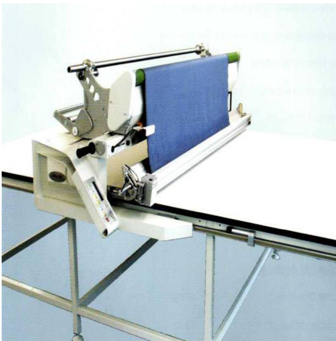
Рис. 11. Настилочные каретки, работающие в полуавтоматическом режиме
