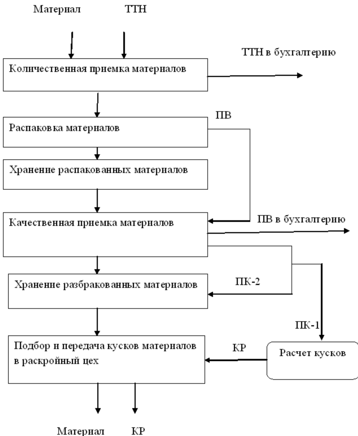
Рис. 7. Блок-схема работ подготовительного цеха и движение документации: ТТН – товарно-транспортная накладная; ПВ – промерочная ведомость; ПК – паспорт куска; КР – карта расчета
