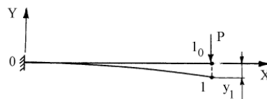
Рис. 3.1. Изгиб жесткой балки
