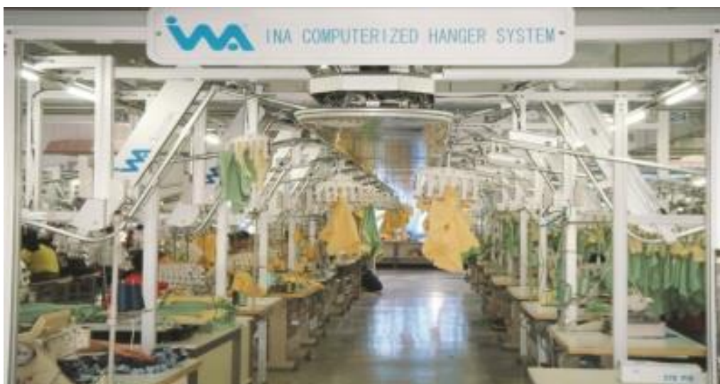
Рис. Е.2. Транспортная система INA в швейном цехе
