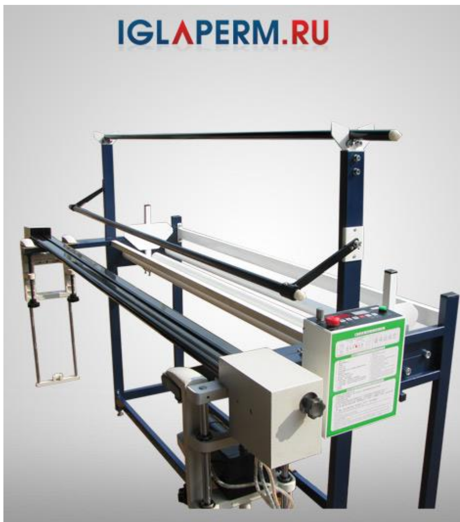
Рис. Е.15. Размоточное устройство для ткани с лотком, с площадкой для установки концевой линейки +концевая линейка
