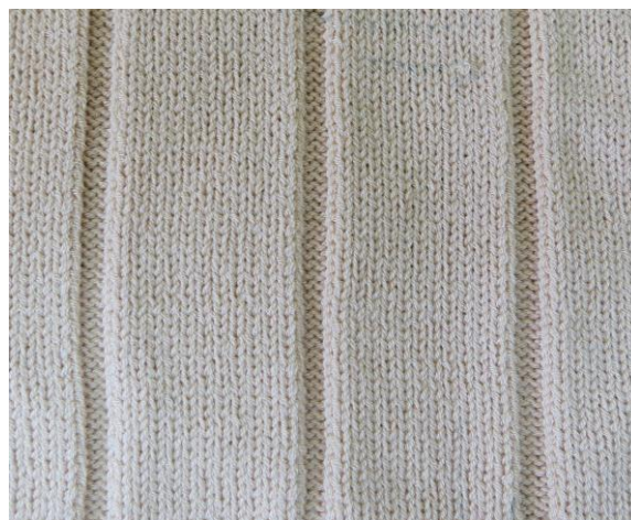
Рис. Д.1. Неполное переплетение на базе ластика: а – лицо; б – изнанка
