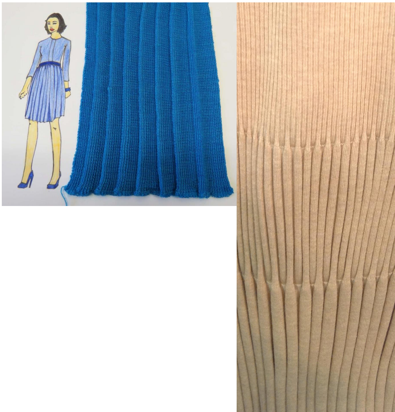
Рис. Д.3. Складки на базе неполных переплетений
