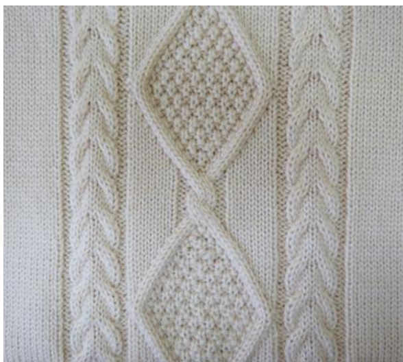
Рис. И.1. Перекрестные переплетения, полученные путем сдвига игольницы
