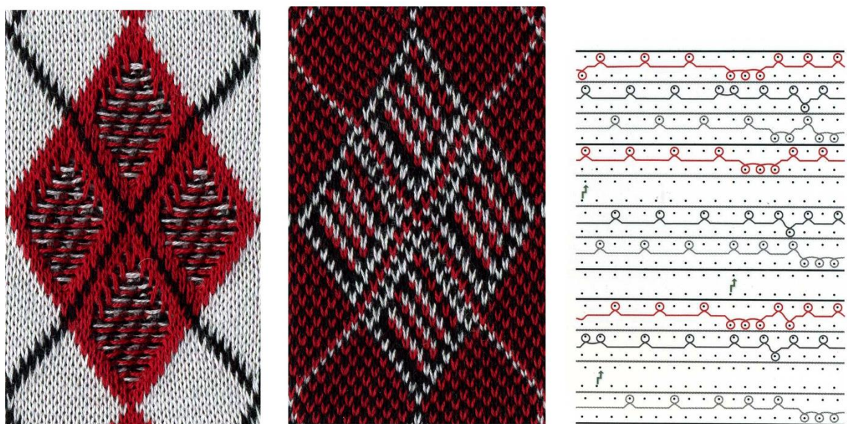
Рис. Г.14. Комбинированное переплетение на базе двойного трехцветного двухстороннего жаккарда (с использованием петлепереноса)
