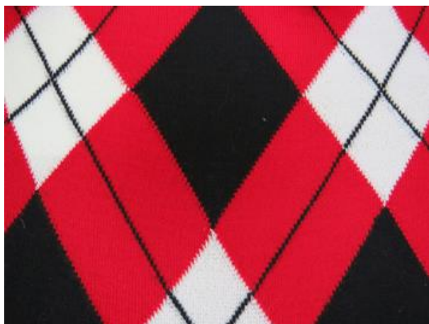
Рис. В.4. Соединение цветных участков в интарзионном трикотаже: a – лицо; б – изнанка
