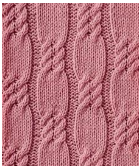
Рис. И.1. Перекрестные переплетения, полученные путем сдвига игольницы
