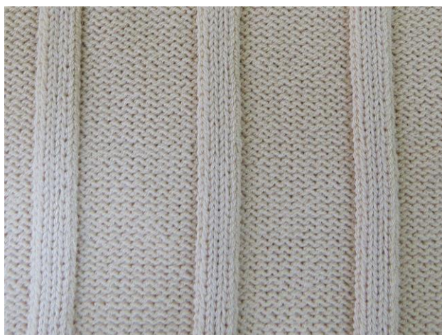
Рис. Д.1. Неполное переплетение на базе ластика: а – лицо; б – изнанка
