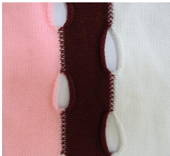
Рис. В.3. Соединение вертикальных полос в сплит – трикотаже: a – лицо; б – изнанка
