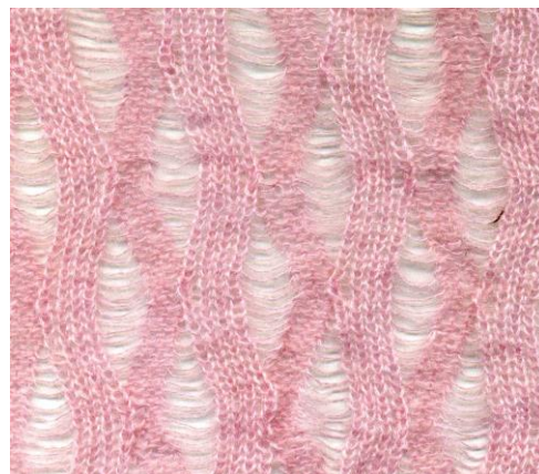
Рис. И.1. Перекрестные переплетения, полученные путем сдвига игольницы
