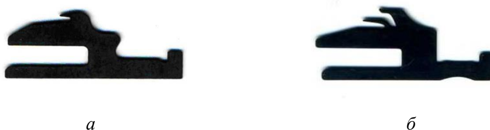
Рис. 22. Платины чулочно-носочного автомата: а – для кулирной глади, б – для плюшевого переплетения
