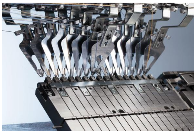
Рис. 40. Интарзийные нитеводы современных плосковязальных машин
